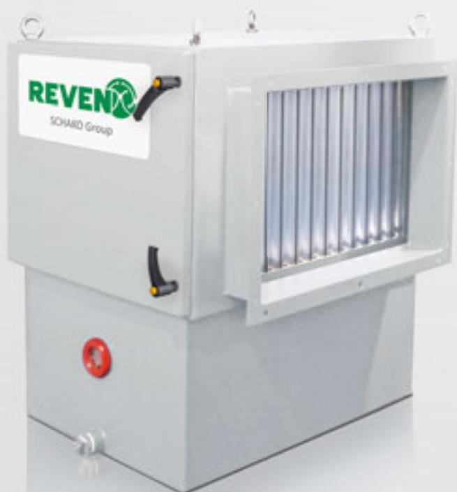
Le module de base X-CYCLONE® est autonettoyant et ne nécessite aucun entretien ! Les aérosols séparés dans le module de base s'écoulent sous forme de masse fluide du haut vers le bas le long des profils X-CYCLONE®. L'écoulement de fluide emporte également les accumulations de matières solides et les élimine des profils du module de base.
